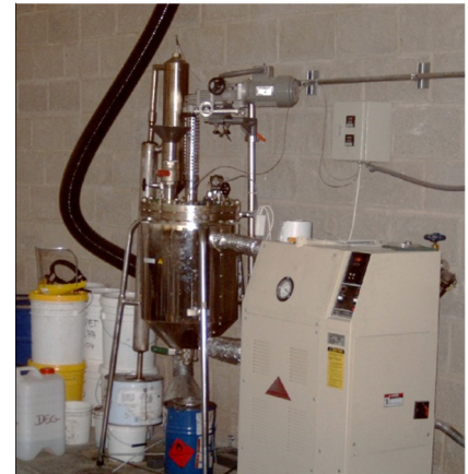
Abbildung 1: Die Herstellung des Formgedächtnispolymers geschieht in einem einstufigen Reaktionsextrusionsprozess bei niedrigen Temperaturen.
