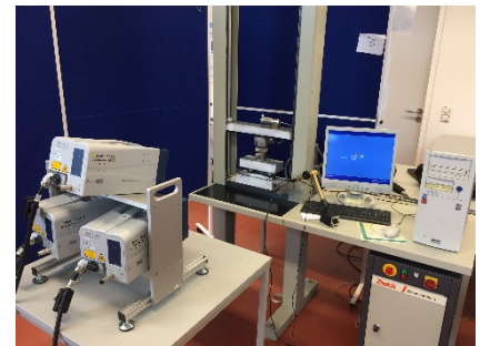
Abbildung 1: Bremsbelag Impedanz Prüfstand
