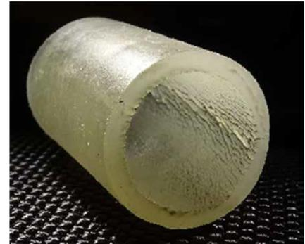
Abbildung 1: PE-Rohr nach 34 Jahre Gebrauch in einer Fußbodenheizung.
