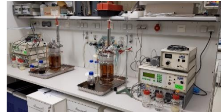
Abbildung 1: Laborfermenter zur Kultivierung von Mikroorganismen
