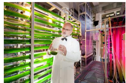
Abbildung 2: Photobioreaktor zur Kultivierung von Mikroalgen
