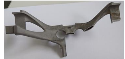
Abbildung 1: Zur Anschauung aufgeschnittenes, topologieoptimiertes Bauteil.
