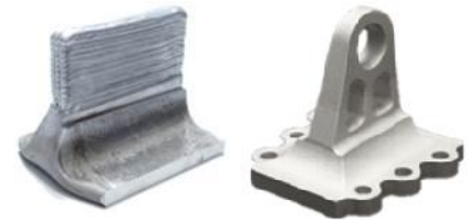
Abbildung 1: Durch MSG-Auftragsschweißanlage gefertigte Bauteile
