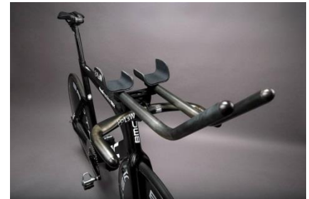
Abbildung 1: Aus FVK hergestelltes und an der BTU produziertes Fahrradcockpit
