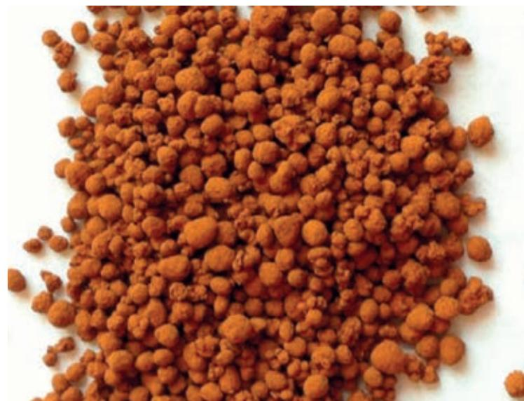
^ Pellets aus eisenhydroxidhaltigem Schlamm zur Schadstoffadsorption in Biogasanlagen und Trinkwasser (Foto: Florian Logsch)
